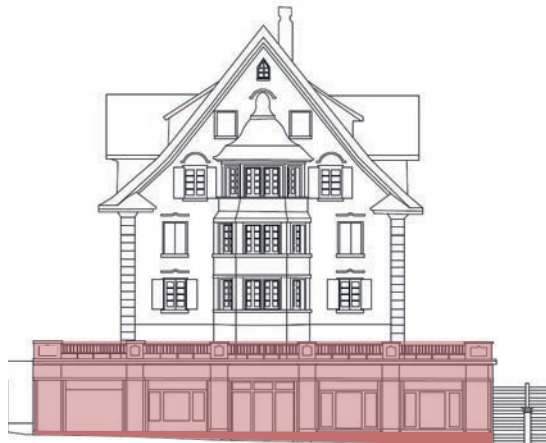
Umnutzung des traditionellen Vorgartens einer barocken Villa: Sockel- und Erdgeschoss ersetzt die Gartenmauern.
